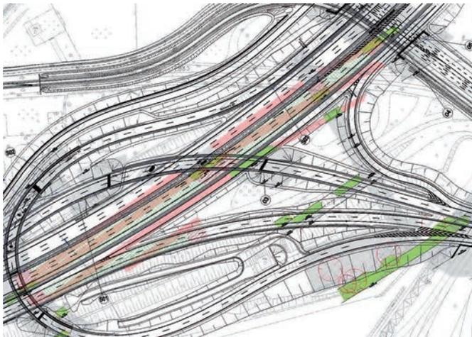
**Bild 20** Einflussbereich der Bergbauflöze (rote Schraffur) auf der A40
