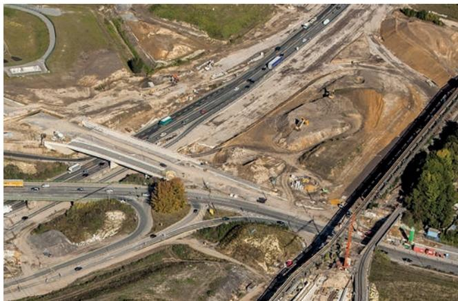
**Bild 4** Luftbild aus 2012 – neue AS Bochum-Stahlhausen im Bau, alte AS BO-Stahlhausen in Betrieb
