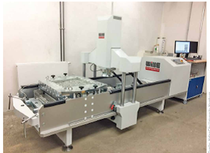
Bild 9 Großrahmenschergerät zur Bestimmung des Herauszieh Widerstands (Bestimmung des Verbundbeiwerts) Large-frame shear tester for determining the pull-out resistance (determination of the composite coefficient)
