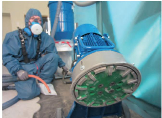
*HUT-Bodenschleifmaschine mit integrierter Unterdrucküberwachung*
